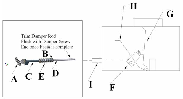
FIGURE 10: DAMPER PARTS
